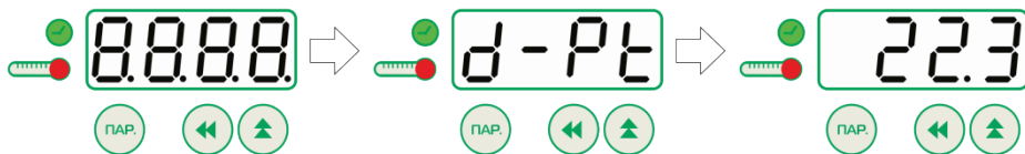
Рисунок 3 - Последовательность показаний дисплея при запуске
